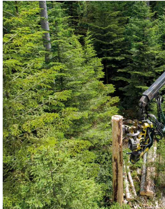
1 Ein Harvester wird nicht nur zum Fällen des nachhaltigen Rohstoffes Holz eingesetzt. Zur Forstwirtschaft gehört auch der Naturschutz. Hier bearbeitet ein Harvester einen Hochstumpf, so dass ein Teil des Stammes als stehendes Totholz im Wald verbleiben kann und zukünftig als wertvoller Biotopbaum dient. Foto: Martin Hertel, BaySF
