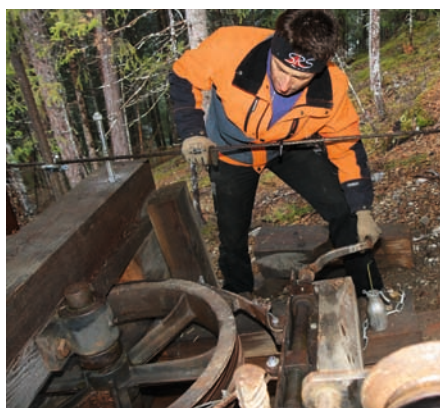
Bereit zur Talfahrt: Die Bremse wird gelöst. Sie besteht aus einem spannbaren Zugband, durch welches passgenaue Holzklötze auf die Seilscheibe gepresst werden.
