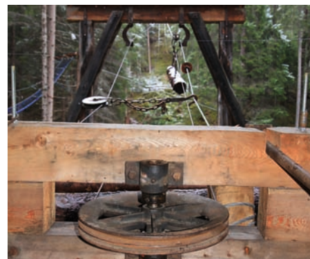
Die auf einem Querholz montierte Zugseilführung mit Fangbügel (l.) sorgt dafür, dass das Zugseil auch bei starken Schwingungen immer wieder auf die Rolle zurückgeleitet wird. Die Umlenkrolle bei der Talstation (r.) hat keine Bremsvorrichtung.
