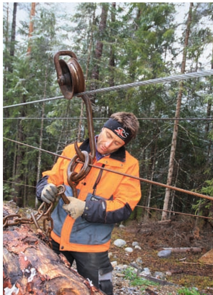
Befestigen der Last: Der Baumstamm hängt an Ketten und wird parallel zum Tragseil mittels Klemmrings (Zugseil) am Bügel des Laufrads (Tragseil) befestigt.
