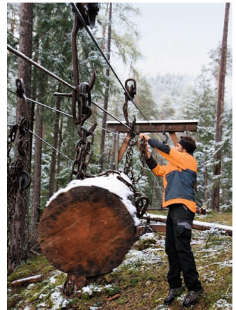
Befestigen der Last: Der Baumstamm hängt an Ketten und wird parallel zum Tragseil mittels Klemmrings (Zugseil) am Bügel des Laufrads (Tragseil) befestigt.
