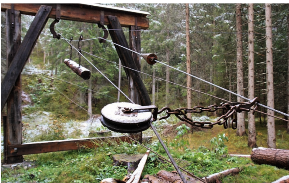
Kurz vor dem Ziel: Um das Entladen zu vereinfachen, klemmt am Tragseil (r.) ein kegelförmiges Hindernis, das die Laufräder automatisch zum Entgleisen bringt.
