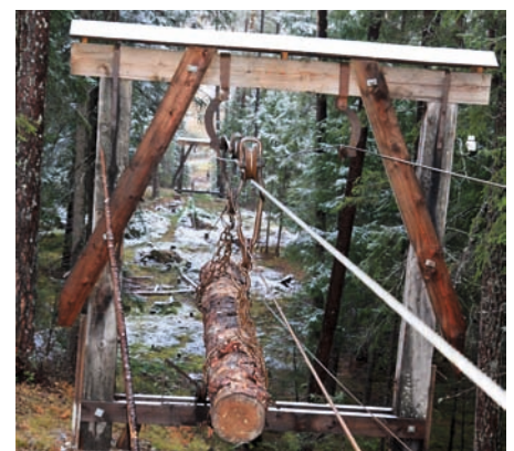
Bereit zur Talfahrt: Die Bremse wird gelöst. Sie besteht aus einem spannbaren Zugband, durch welches passgenaue Holzklötze auf die Seilscheibe gepresst werden.
