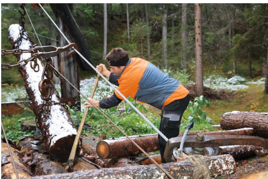
Das vordere Laufrad ist entgleist. Mit dem Zappi wird der Stamm schliesslich von der Entladerampe gerollt, damit die nächste Last ungehindert einfahren kann.
