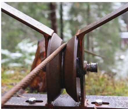
Die auf einem Querholz montierte Zugseilführung mit Fangbügel (l.) sorgt dafür, dass das Zugseil auch bei starken Schwingungen immer wieder auf die Rolle zurückgeleitet wird. Die Umlenkrolle bei der Talstation (r.) hat keine Bremsvorrichtung.
