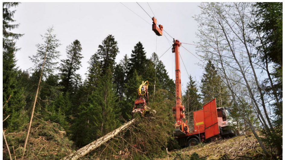
Abbildung 5: Im steilen Gelände werden hochmechanisierte Holzernverfahren immer öfter eingesetzt. Im Bild ein Gebirgsharvester
