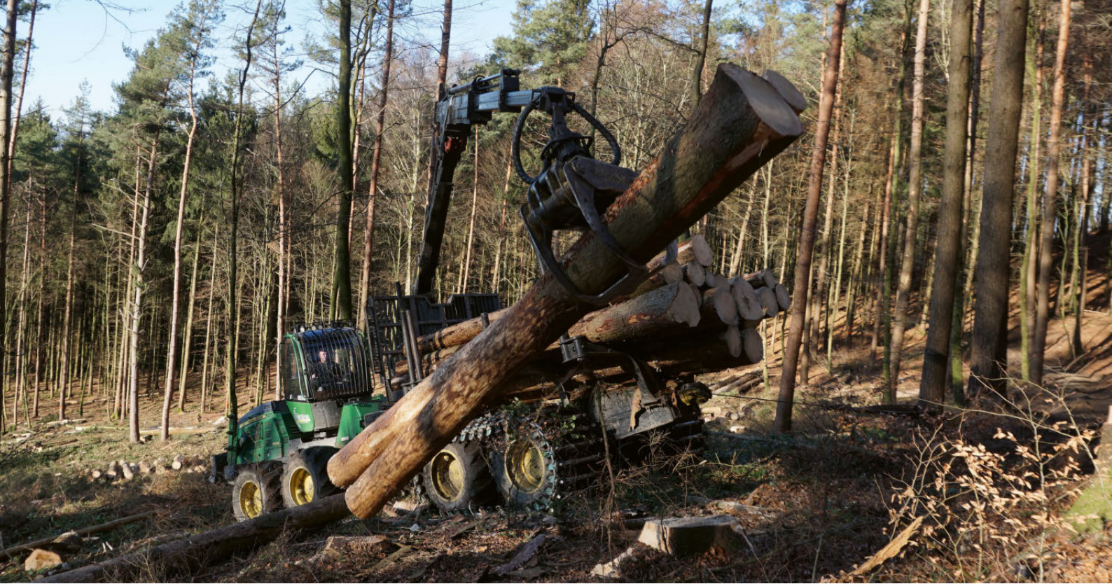
Abbildung 1: Holzrücken mit Forwarder mit Traktionsunterstützung (teil- oder vollmechanisierte Holzernte)
